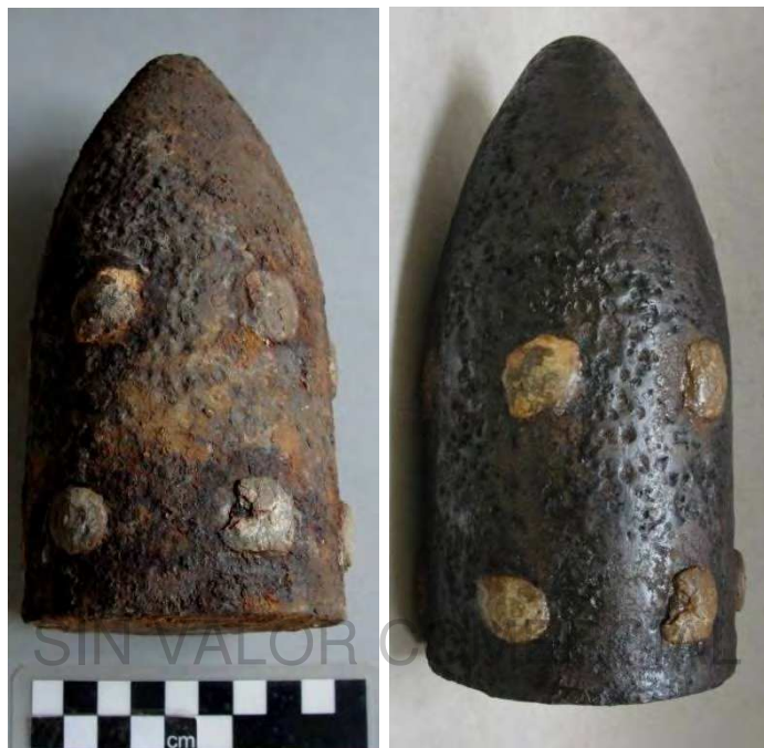
Figura 1. Proyectoil cónico sistema Lahitte, de la década de 1890, desenterrado en el año 2013 en la base de la Fortaleza del Cerro de Montevideo. Este artefacto mixto, combinación de un cuerpo macizo de hierro y proyecciones semi-esféricas de plomo, demandó la aplicación de distintas técnicas de limpieza mecánica y química de las incrustaciones y productos de corrosión, de estabilización de la oxidación y de impermeabilización (Pieza n° LAHITT 2511 - Museo de la Fortaleza del Cerro)
